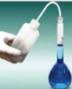
خطوة 3 يضاف الماء المقطر إلى المذاب حتى يصل مستوى المحلول إلى العلامة المحددة على الدورق.
