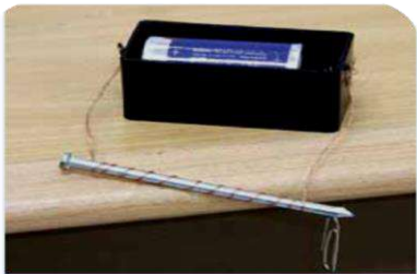
يزيد القلب الحديدي داخل الملف من المجال؛ لأن القلب يصبح ممغنطاً.
